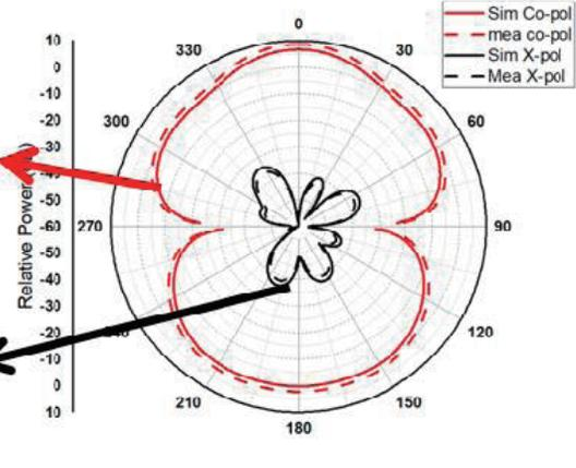
FIGURE 11. 2D radiation pattern (*H*-plane).
