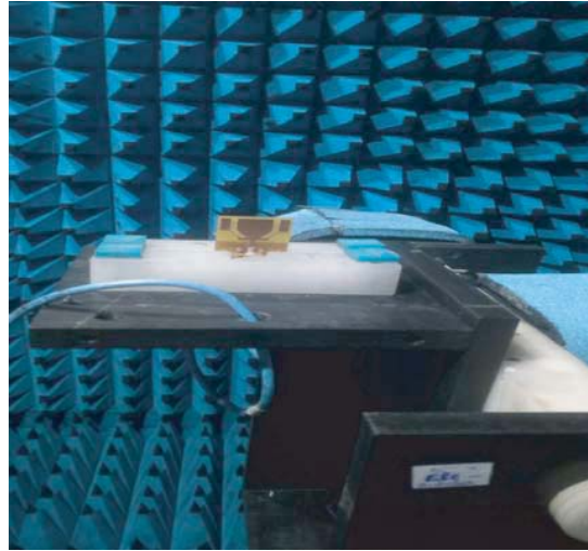
(d) Antenna snap in anechoic chamber
