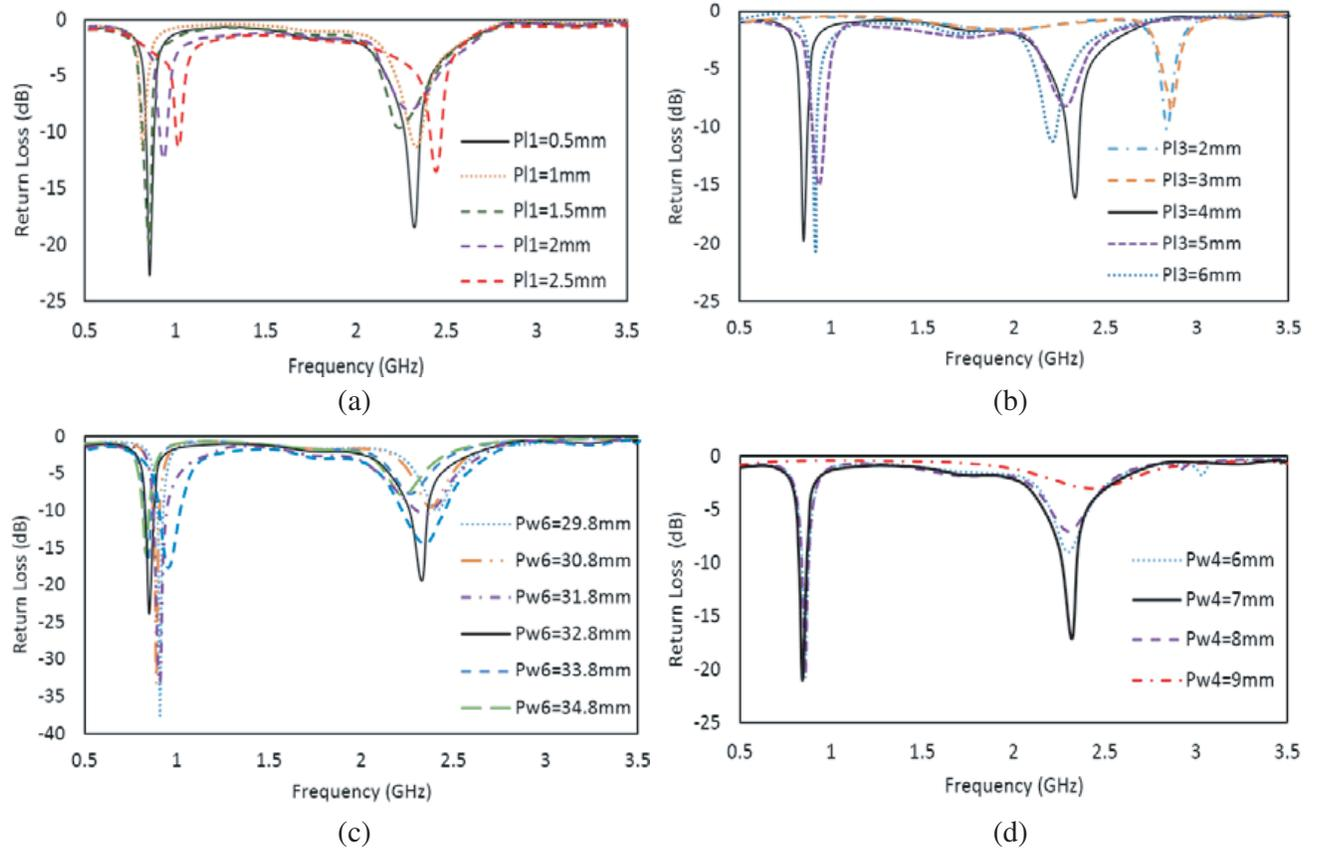
Figure 4. Parametric variation of (a)  $Pl_1$ , (b)  $Pl_3$ , (c)  $Pw_6$  and (d)  $Pw_4$ .
