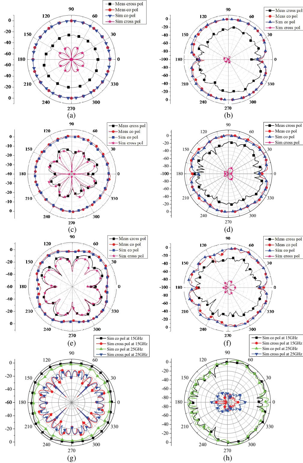
**Figure 8.** The radiation pattern of the fabricated cone antenna. (a)  $xy$ -plane at 2 GHz. (b)  $yz$ -plane at 2 GHz. (c)  $xy$ -plane at 4 GHz. (d)  $yz$ -plane at 4 GHz. (e)  $xy$ -plane at 6 GHz. (f)  $yz$ -plane at 6 GHz. (g)  $xy$ -plane at 15 GHz and 25 GHz. (h)  $yz$ -plane at 15 GHz and 25 GHz.
