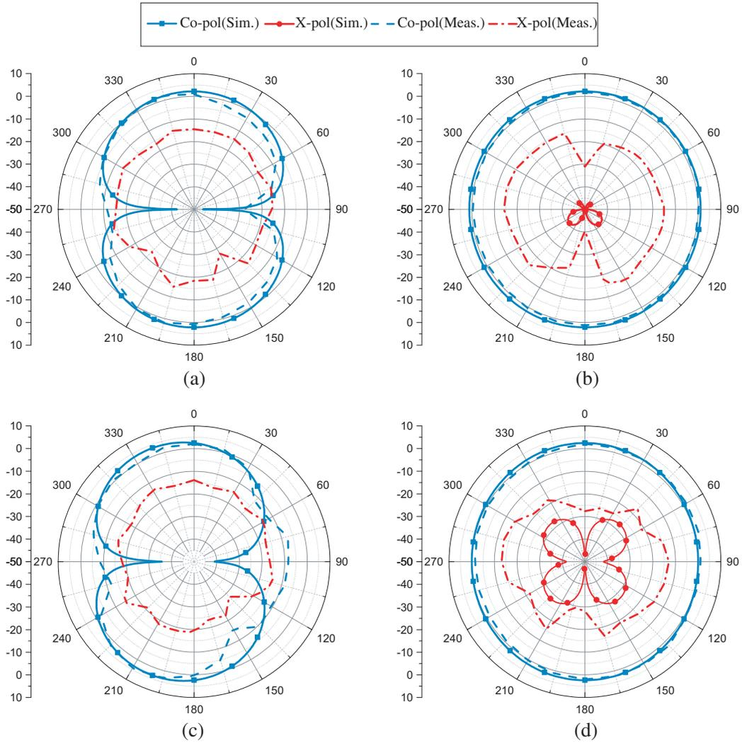
**Figure 7.** Simulated and measured radiation patterns of the proposed antenna: (a)  $yz$ -plane ( $E$ -plane) at 1.84 GHz; (b)  $xz$ -plane ( $H$ -plane) at 1.84 GHz; (c)  $yz$ -plane ( $E$ -plane) at 3.08 GHz; and (d)  $xz$ -plane ( $H$ -plane) at 3.08 GHz.
