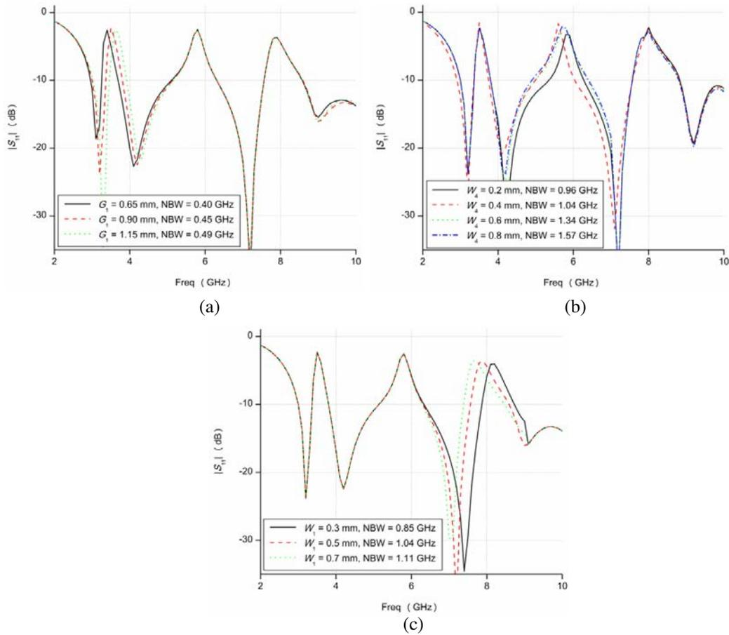
**Figure 3.** Variation in notch, (a) slot width of IUDMS ( $G_1$ ), (b) width of UDMS ( $W_4$ ), (c) width of CSRR ( $W_1$ ).
