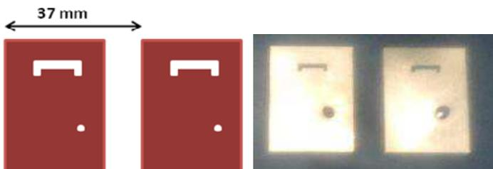
Figure 4. The  $1 \times 2$  linear array antenna.
