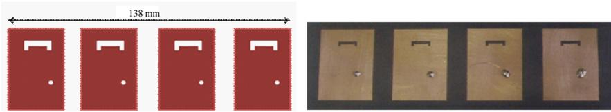
**Figure 7.** The  $1 \times 4$  linear array antenna.
